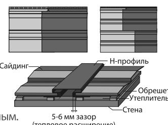
**Стык с использованием H-профиля:** H-профиль монтируется на обрешетку. Панели сайдинга просто вставляются в H-профиль с соблюдением зазора в 5-6 мм. При установке в холодную погоду оставляйте зазор в 9-10 мм.
