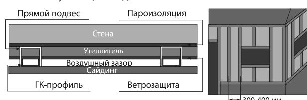
Чтобы создать ровную поверхность для обшивки и избежать волнистых поверхностей, обрешетка выравнивается при помощи прямых подвесов.
